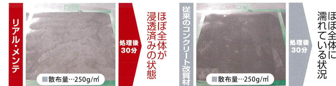
左記1の試験結果より、固体物であるケイ酸塩類が、他社改質材よりも速く多く浸透することが証明され、本剤は散水養生が不要と確認しました。
